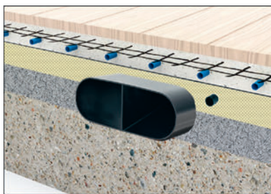
Flatkanal delvis i utjämningskiktet och cementgolvet med armering.
