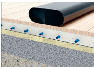
Flatkanal på golvbeläggningen
